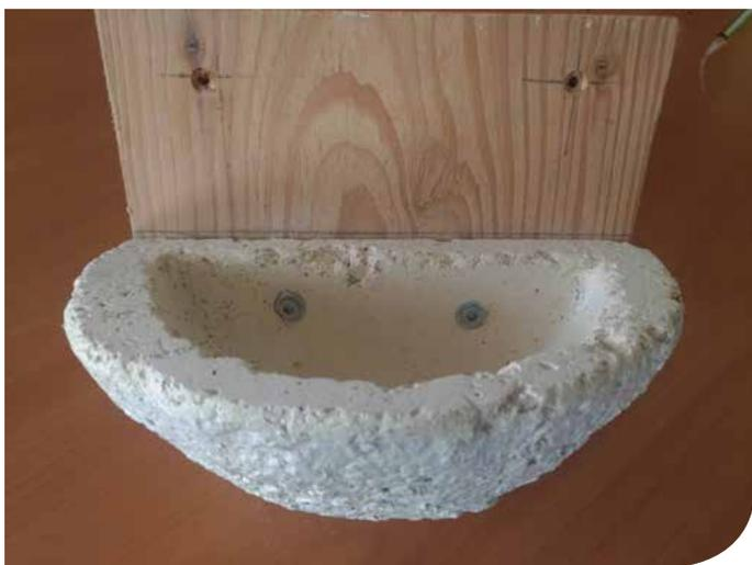
*Exemples de fixation des moules sur un support en bois avant pose sur le bâti*
